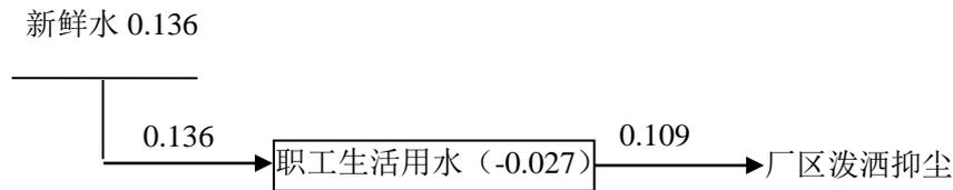
图 3-1 现有工程水平衡图（单位：m<sup>3</sup>/d）
